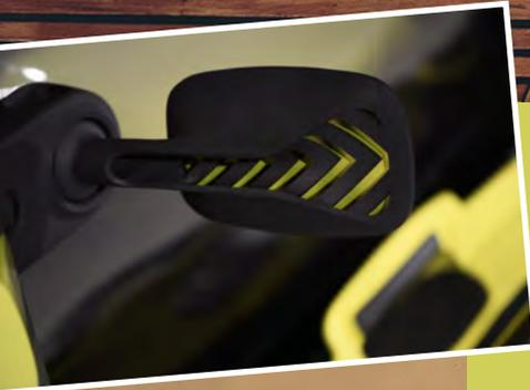
Les rétroviseurs extérieurs réglables grâce à la rotule intégrée au dispositif de fixation, s'emboîtent aux emplacements prévus dans les montants de portes. Ils sont également amovibles.
