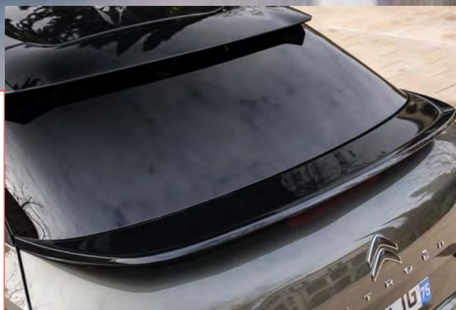
*Le large pare-choc est constitué de plastique brut digne des SUV remontant jusqu'à la base du hayon, avec le risque qu'il soit rapidement rayé. Contrainte aérodynamique oblige, un large becquet est posé à la base de la lunette arrière, il permet à C5 X d'offrir un très bon CX lui permettant d'être économe en carburant, le large becquet fait miroir à un large spoiler sur le haut de la lunette arrière qui, lui, n'est là que pour le style*
